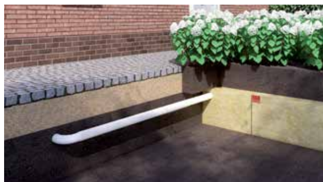
06. Infiltratie op de zuidzijde van de woning.
