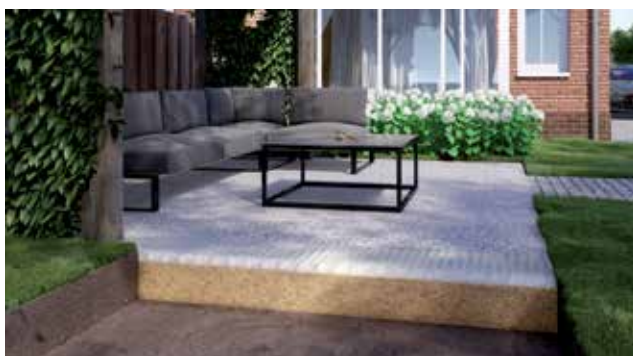
05. Infiltratie door middel van halfverharding.
