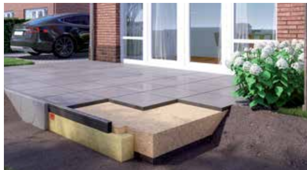
02. Infiltratie langs het terras met infiltratiebuffer.
