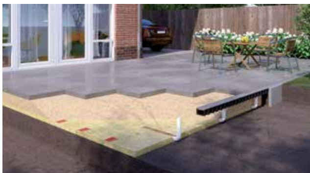
03. Infiltratie van regenwater direct onder het terras.
