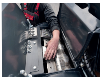
Uitgevoerd met snelwisselmessen
