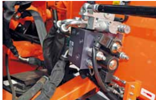
Eigener Hydraulikkreislauf, hydraulische Schnittlängenverstellung 0 - 25 mm
