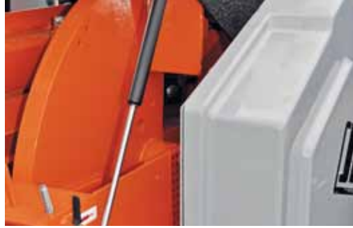
Gasdruckdämpfer zur ergonomischen Öffnung der Tunnelhaube
