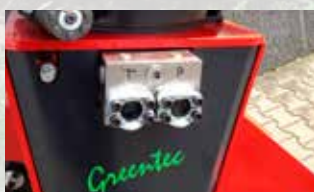
Hydraulische componenten zijn hoog opgebouwd
