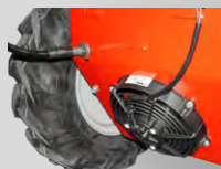
Elektrische koeling van de transmissie (voor gebruik het hele jaar door)
