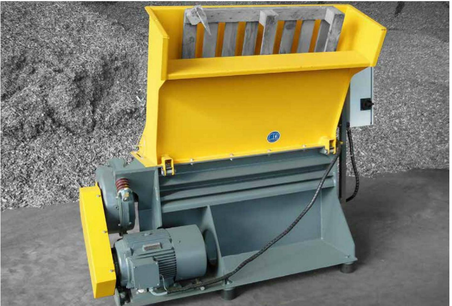
Der handbeschickte Palettenhacker SPE 1300 wurde eigens für die Zerkleinerung von Paletten und Holzabfällen zu hochwertigen Holzhackschnitzeln konstruiert. Es können naturbelassene Paletten, die normalerweise entsorgt werden müssen, zu einem wertvollen Brennstoff umgewandelt werden. Die stationär betriebene Maschine produziert vollwertige Holzhackschnitzel mit einer Größe von 30-50 mm. Es können in der Stunde bis zu 30 Paletten zerkleinert werden.
