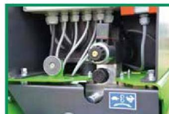
Einzugsgeschwindigkeit regelbar durch Mengenteiler
