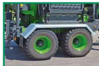
*Tandem-Fahrwerk bis 80 km/h*
