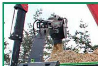
*Auswurfzyklon zur Staubreduzierung*
