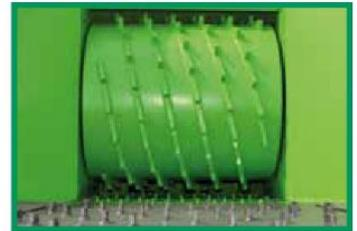
*Anpressrolle mit Stahlzähne
