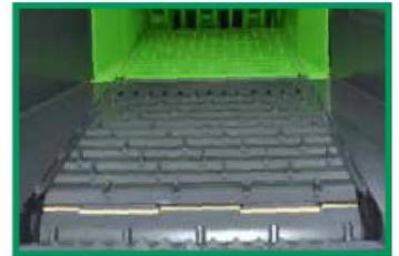
*Integriertes Kettenband im Einzugstisch*
