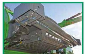
*Vorgelagerte Einzugswalze mit starkem Hydraulikantrieb*
