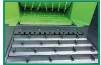
*Einzugsklappe mit Kettenband*
