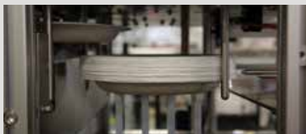
3 - STAPELN EINZELNER TELLER Das Hubgitter senkt sich mit zunehmendem Stapel allmählich ab, um unterschiedlich hohe Stapel zu ermöglichen
