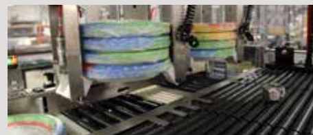
4 - STAPELN VON TELLERN IN BÜNDELN Aufstapeln des Produkts für die Kartonierung nach dem Einwickeln in Folie
