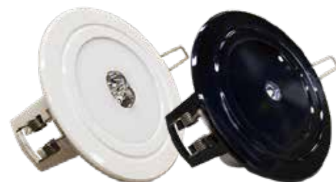
Montage infälld i u-tak: 90 mm Ø Inbyggnadsdjup: 43 mm Montagehål: 74 mm Ø
