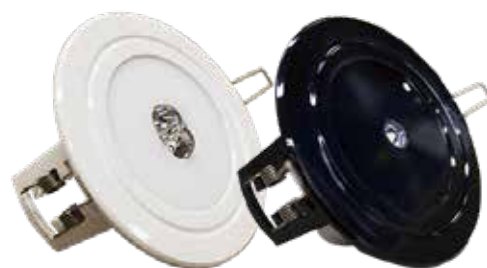
Montage infälld i u-tak: 90 mm Ø Inbygggnadsdjup: 43 mm Montagehål: 74 mm Ø
